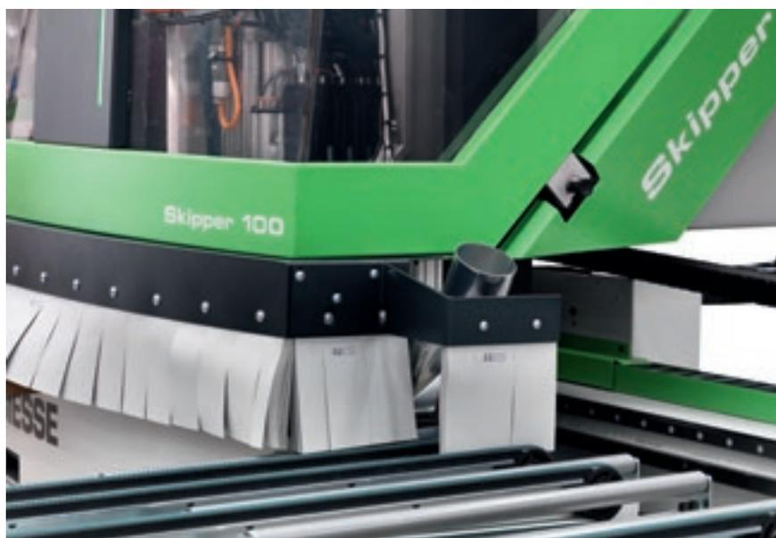
Couvertures insonorisées des unités d'usinage, avec barrières à bandes pour la protection contre les poussières et les déchets et aspiration intégrée.
